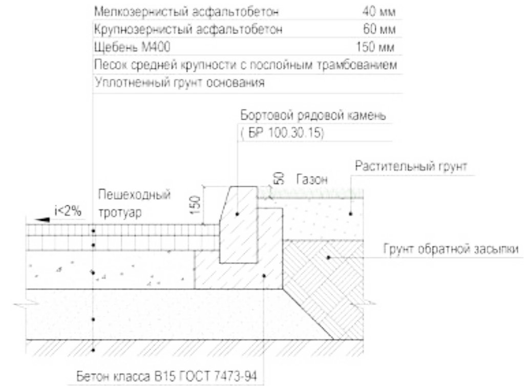
3.13.1 Схема устройства сопряжения асфальтобетонного покрытия и газона
