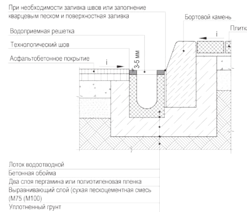
3.22 Узел устройства водоотводного лотка в асфальтобетон с примыканием к бортовому камню
